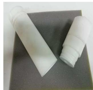
Figura 7 # Contentor submarino construído no torno CNC durante a colaboração de formação dos alunos finalistas do Curso de Eng. Mecânica do ISE/UALG
