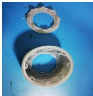
Figura 6 # Molde/suporte de transdutor PVDF construído na impressora 3D do Tec4Sea para o projeto 2DeepScape
