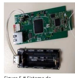
Figura 5 # Sistema de armazenamento e conversão Analógica Digital para o hidrofone PVDF
