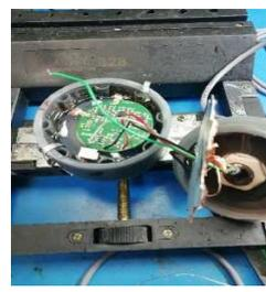
Figura 4 # Pré-amplificador e adaptação de impedância do hidrofone PVDF
